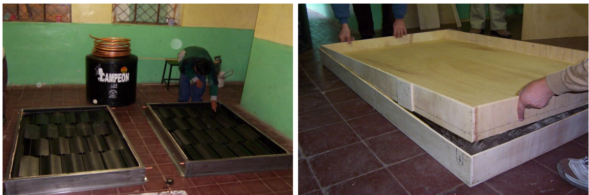
Figure 4: Capteur complet dans leur caisse de métal (gauche). Il manque à poser la vitre dessus. Sous l'échelle, une double caisse en bois emprisonne une fine pellicule d'air qui assure l'isolation (droite). Les pertes de chaleur par rayonnement sont limitées en utilisant des couvertures de survie (principe du thermos).
