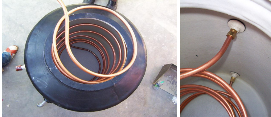
Figure 5: L'échangeur de chaleur est placé dans le réservoir d'eau. Les connections sont assurées grâce à des jonctions en bronze.
